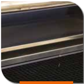
zusätzliche Absaugung durch Kanäle seitlich der Arbeitsfläche
